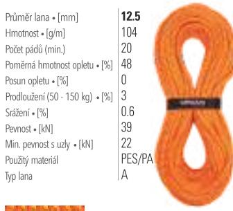
Kombinace polyamidu a polyesteru dává lanům řady Timber Evo mimo jiné výbornou odolnost vůči oděru a také vysokou pevnost. Průměr 12.5 mm zajišťuje vysokou kontrolu při manipulaci.
