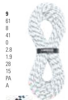
Statické lano díky unikátní konstrukci a nejnovějším technologickým úpravám vykazuje pevnost vyšší než 22 kN a splňuje min. 5 pádů se 100 kg závažím (oproti závaží 80 kg pro lana typu B). Pevnost lana s uzly je vyšší než 15 kN po dobu 3 min bez poškození jádra i opletu (lana typu B jsou testována na 12 kN po dobu 3 min). Výhodu ocení pracovníci ve výškách a záchranné sbory.
